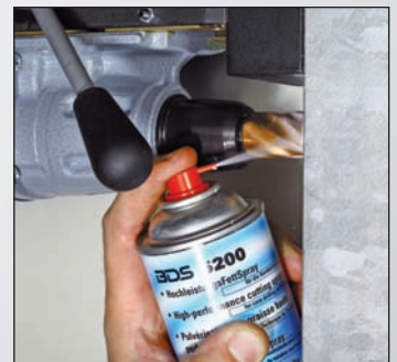
Schritt 2: Während des Bohrens Hochleistungs-fettspray auf die Bohrspitze und in die Bohrung sprühen.
