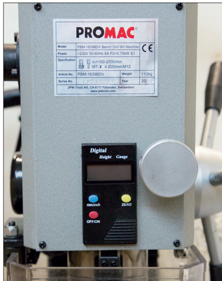
Die Bohrtiefenanzeige ist digital
