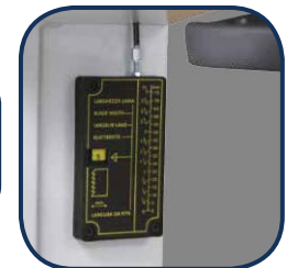
Im Maschinenrahmen integrierte Anzeige der Sägebandspannung für verschiedene Bandbreiten
