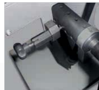
Reihenbohrungen durch Dübelbohrereinrichtung mit Rasterteilung 16/20/22/25 mm möglich
