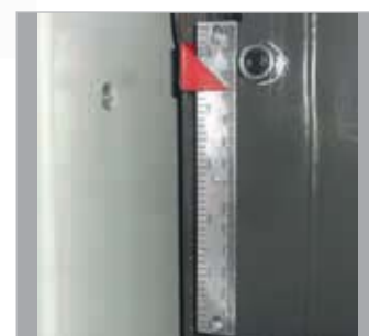
Eingestellte Höhe des Arbeitstisches zusätzlich über Skala ablesbar
