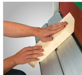
Gehrungen bis 45° durch Schwenken des Längstisches
