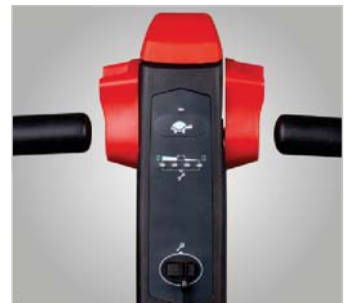
> Gut erreichbarer Low-Speed-Taster für langsames Rangieren bei senkrechter Deichsel > Batterieentladeanzeige über LED > Entsperrern des Hubwagens mit elektronischem Schlüssel
