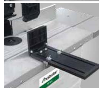
Spannwinkel mit langen Führungen zum Spannen verschiedener Werkstückhöhen
