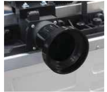
100 mm Anschlussstutzen für externe Absaugung
