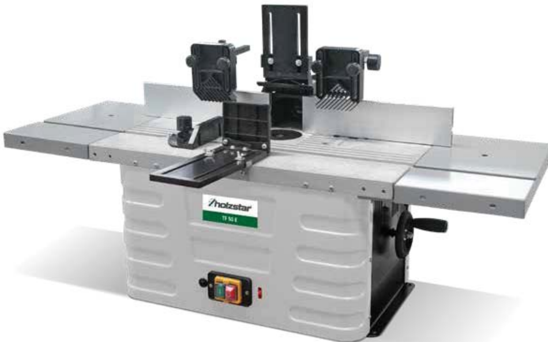
Spindelhöhe von 0 bis 40 mm einstellbar
