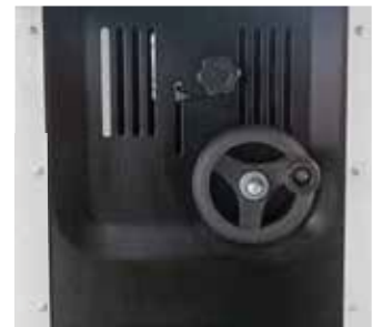
Spindelhöhe von 0 bis 40 mm einstellbar
